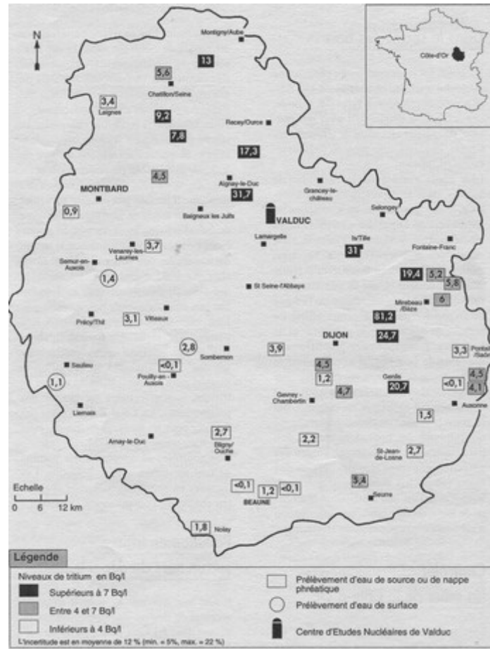
Fig. 4. Contamination 1994 en tritium des réseaux d'eau potable de Côte d'Or. Le tiers NE du département est impacté par le CEA Valduc. On remarque un 80 Bq/l à une vingtaine de km de Dijon. La Haute-Marne au NE (Ouest de Langres, non étudiée) est forcément impactée aussi, le vent dominant étant de SW. Beaucoup de ces rejets étaient aériens, la végétation/potagers/lait de la zone sont forcément "marqués" au tritium de la même manière; Info CriiRad n°4, nov. 1995
