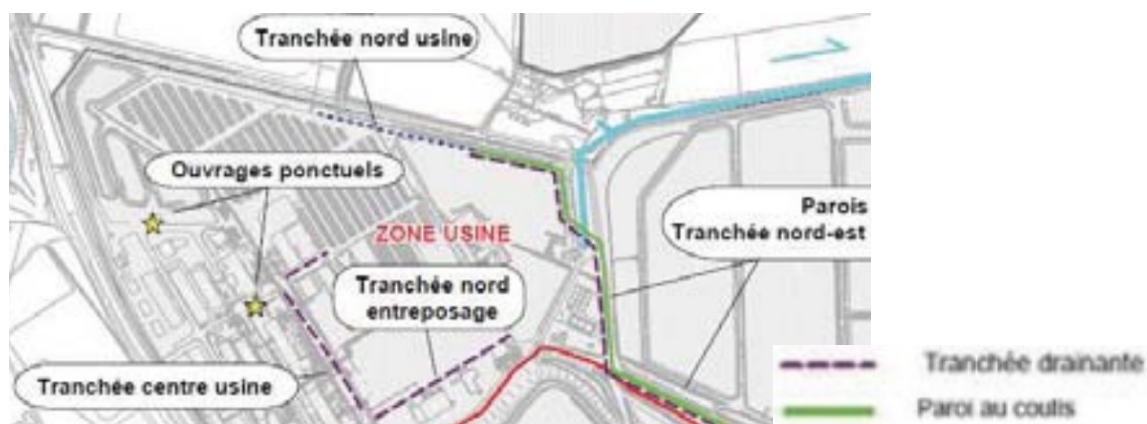
Fig. 5. Aménagements pour le contrôle de la nappe phréatique alluvionnaire entre des ateliers de l'usine chimique et en bordure Nord et Est en 2012-2013, tranchées et puits (in Areva 2013, p. 233).
