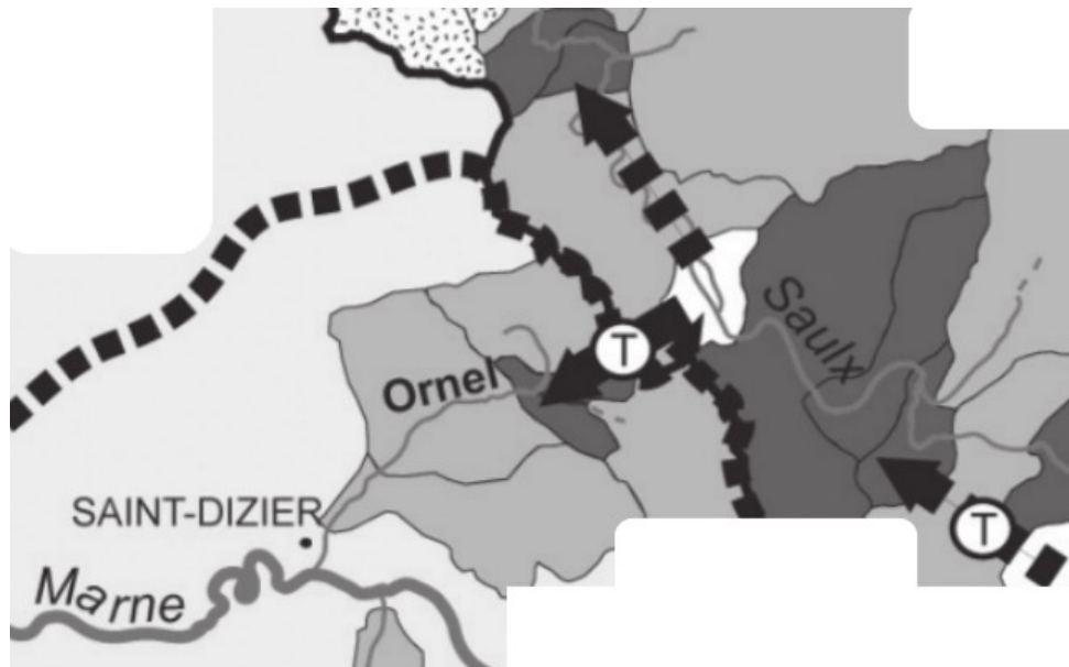
Fig. 22. Cartographie hydrologique des rendements spécifiques et des circulations. Même légende que Fig. 21, en gris net : secteur "moyen" ; en blanc : secteurs de pertes ; en gris-foncé : secteur à rendement fort, sortie de nappes; en gris très pale : pas de données exploitables ; en pointillés-sable : zones d'infiltration généralisée. La grosse ligne en pointillés +rapprochés sépare les bassins versants de la Marne et de la Saulx.
